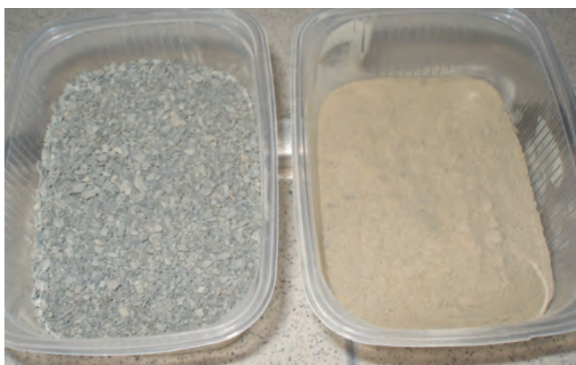
Внешний вид цеолитового туфа Люльинского месторождения в зависимости от степени измельчения породы (2–4 мм и 0,15 мм)
