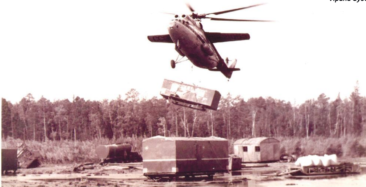
Рис. 1. Переброска оборудования буровой бригады вертолётom Ми-6 на Холмогорскую площадь. ХМАО. 1979 г. МГНГ-НВ-8793.
